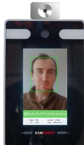
Nova generacija detekcije temperature tela bazirana na metodi „AI face recognition“ kao prevencija širenja virusa u direktnim kontaktima. Primenjeni algoritam detekcije visoke preciznosti omogućava tačno merenje temperature tela nezavisno od toga da li se nosi maska ili ne.
